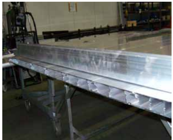
Vorspannung nach INNEN nach dem zusammen snapen!
